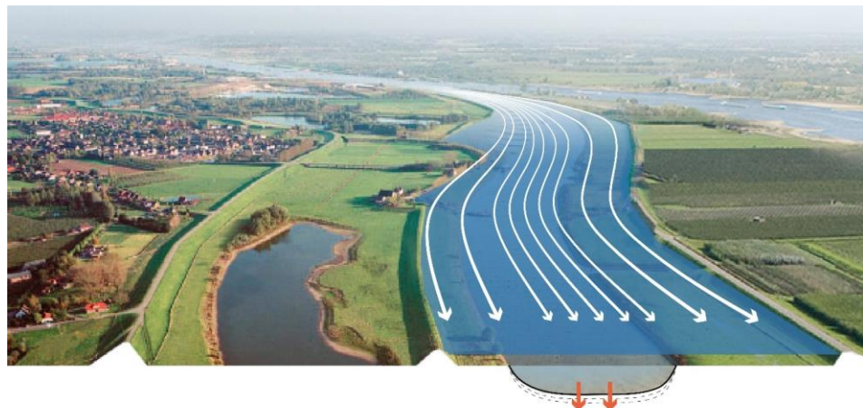
Figuur 5: Effect zomerkades. De witte pijlen geven een indicatie van stroombanen. Oranje pijlen geven de bodemerosie aan.
